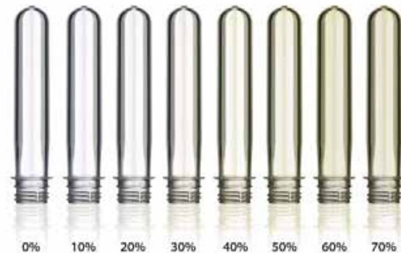
Variación del color de la preforma en función del nivel de reciclado, de 0% a 70%.
