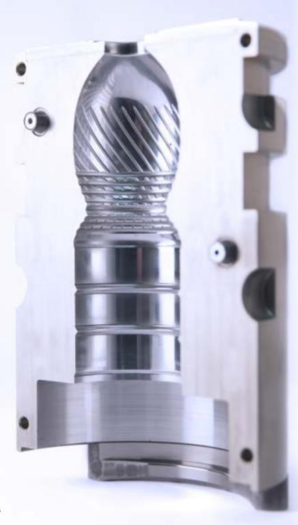
ahora prácticamente se incorporan en todos los moldes numerosos orificios de ventilación en posiciones bien definidas para permitir el paso de aire hacia el exterior del molde.
