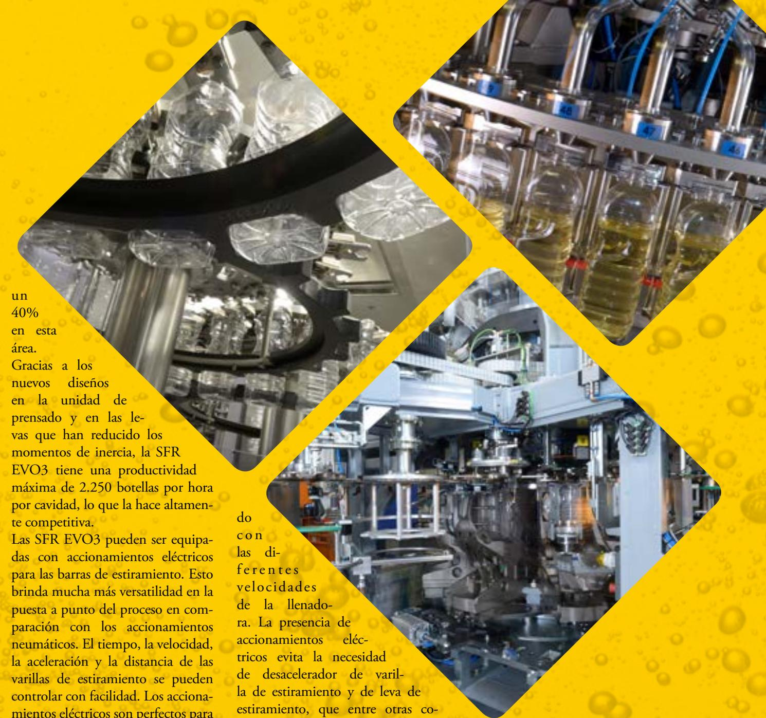
también se reducen gracias al nuevo sistema de cambio de molde estándar en la SFR EVO3 que es rápido y fácil de usar. Con el sistema estándar de cambio de molde, cada cavidad se puede cambiar en 100 segundos, que es bastante rápido. Pero con los sistemas opcionales, en los cuales no se utilizan herramientas, para cambios súper rápidos de las partes y el fondo del molde, ese tiempo puede ser acortado a tan sólo 35 segundos.
