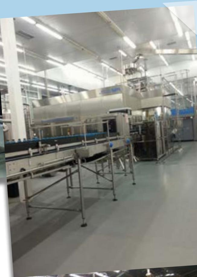
bidas con las que puede trabajar: con sus válvulas de llenado controladas por caudalímetro magnético, la unidad Isotronic HR proporciona un muy alto rendimiento y precisión.” Arca Continental es un cliente de larga data de SIPA. En su planta de Guayaquil, Ecuador, tiene por ejemplo, dos sopladoras rotativas SIPA SFR 12 EVO y una línea completa de soplado y embotellado formada
